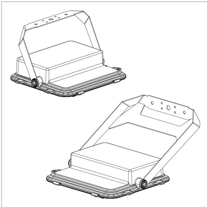
TFLEX BASE | Fixação com varão roscado
