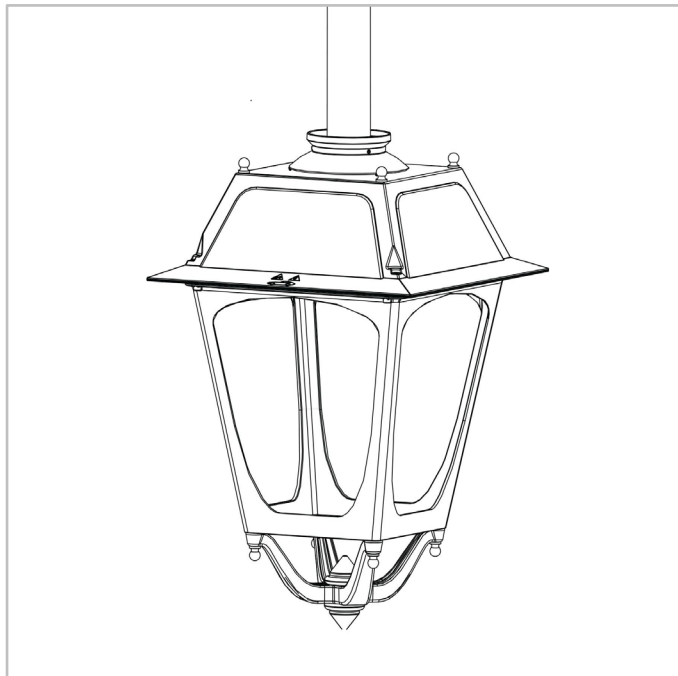
VALENTINO GEN2 | Montaje suspendido con fijación de gas de ¾"
