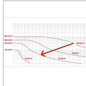
Advanced Tunnel System 4 puede enlazarse a un sistema de monitorización del tráfico para obtener datos de velocidad o densidad y así adaptar el nivel de iluminación en función de las normas de seguridad.
