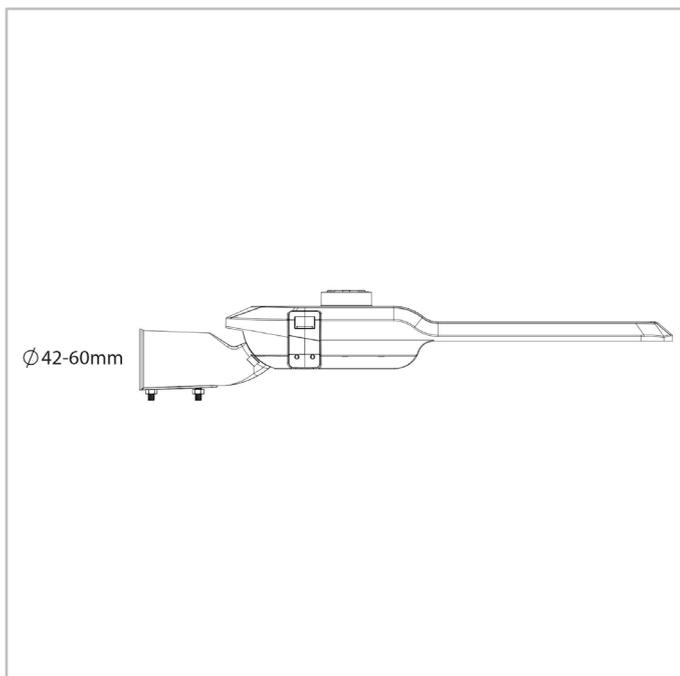
INTILUM | Montaje post-top apto para espigas de Ø42-Ø60 mm (2 tornillos M8)
