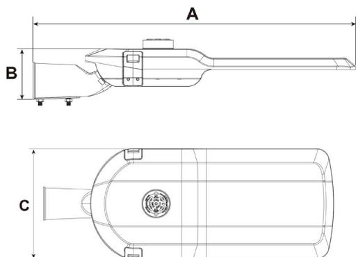
INTILUM | Montaje de entrada lateral apto para espigas de Ø42-Ø60 mm (2 tornillos M8)
